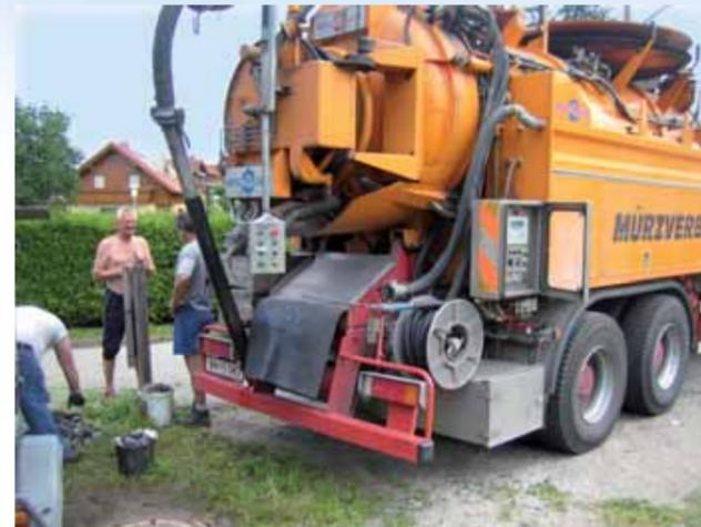
Um das insgesamt über 106 km lange Kanalnetz des Mürzverbandes warten und reinigen zu können, steht ein Kanalspülwagen mit einer Wasser-Recyclinganlage zur Verfügung.
