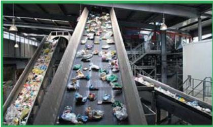
Die vielen unterschiedlichen Kunststoffe im Gelben Sack müssen zunächst einmal sortiert werden. Die genaue Sortierung der Verpackungen ist die wichtigste Voraussetzung für ein Recycling zum Granulat.
