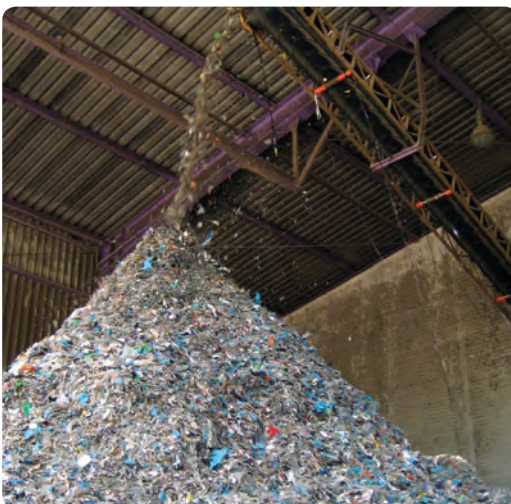
Behandelter Restmüll nach dem „Splitting“, der als Ersatzbrennstoff dient
