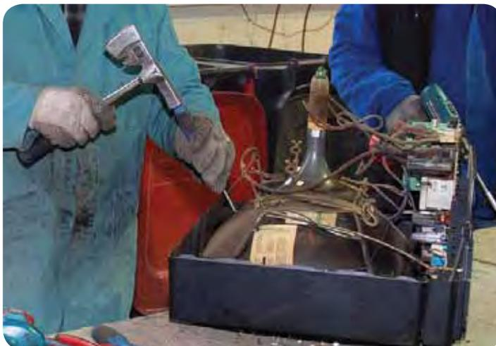
Zerlegung eines Fernsehgerätes
