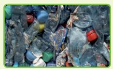
Kunststoffverpackungen werden zu einem großen Teil zu Granulat verarbeitet, um daraus neue Flaschen, Säcke, Rohre, Büroartikel etc. herzustellen. Aus PET-Flaschen werden wieder neue PET-Flaschen sowie Fleece-Pullover und Schlafsackfüllungen hergestellt. Nicht stofflich verwertbares Material wird als Brennstoff genutzt.
