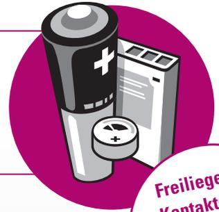
Freiliegende Kontakte der Lithium-Batterien/Akkus bitte abkleben!
